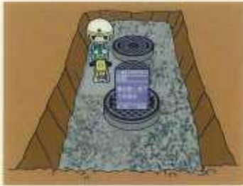
⑬ 埋め戻し完了、つき締め
