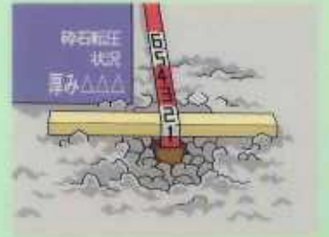
⑤ 基礎砕石 厚み確認
