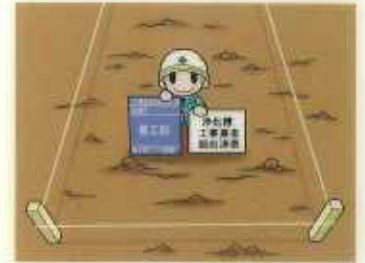
① 着工前 浄化槽設備士監督 ※背景に工事を行う場所の周辺状況を写す
