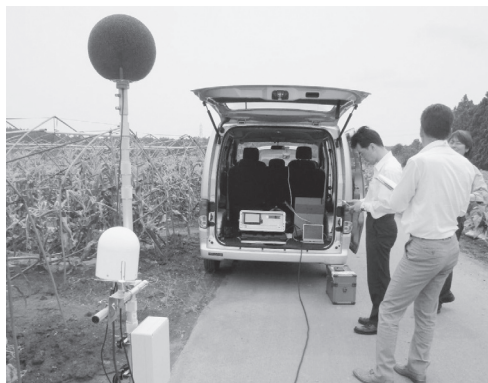
市が実施した航空機騒音自動測定器を使ったデモ測定の様子
