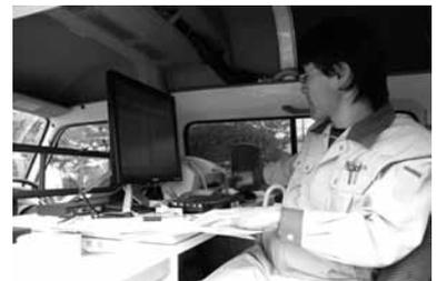
モニタリングカーで放射線量を測定
