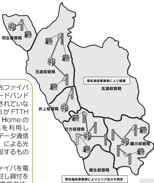
この工事は、光ファイバ網を使ったブロードバンドサービスが提供されていない地域へ、本市がFTTH (Fiber To The Homeの略。光ファイバを利用した家庭用の高速データ通信サービスのこと) による光ファイバ網を敷設するものです。
