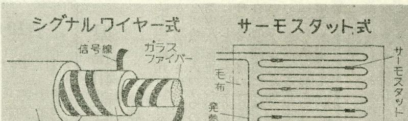
右はサーモスタット式電気毛布の配線、黒い部分が安全を守るサーモスタット。左はシグナルワイヤー式毛布の発熱体、毛布全体を二の線でおおい、どの部分の過熱でも信号線がはたらく
