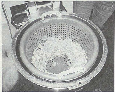
↑脱水機（野菜が傷まないよう脱水しパック詰めし出荷している）
