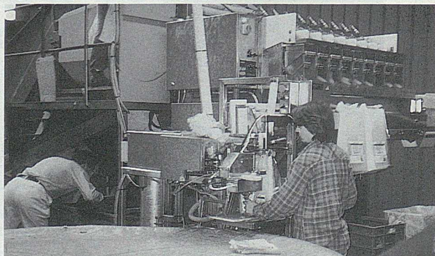
同 上 ニンジンの自動包装機。ここでは、販売先のスーパーごとに規格や本数を変えて袋詰めされる。袋も何種類も用意されている。
